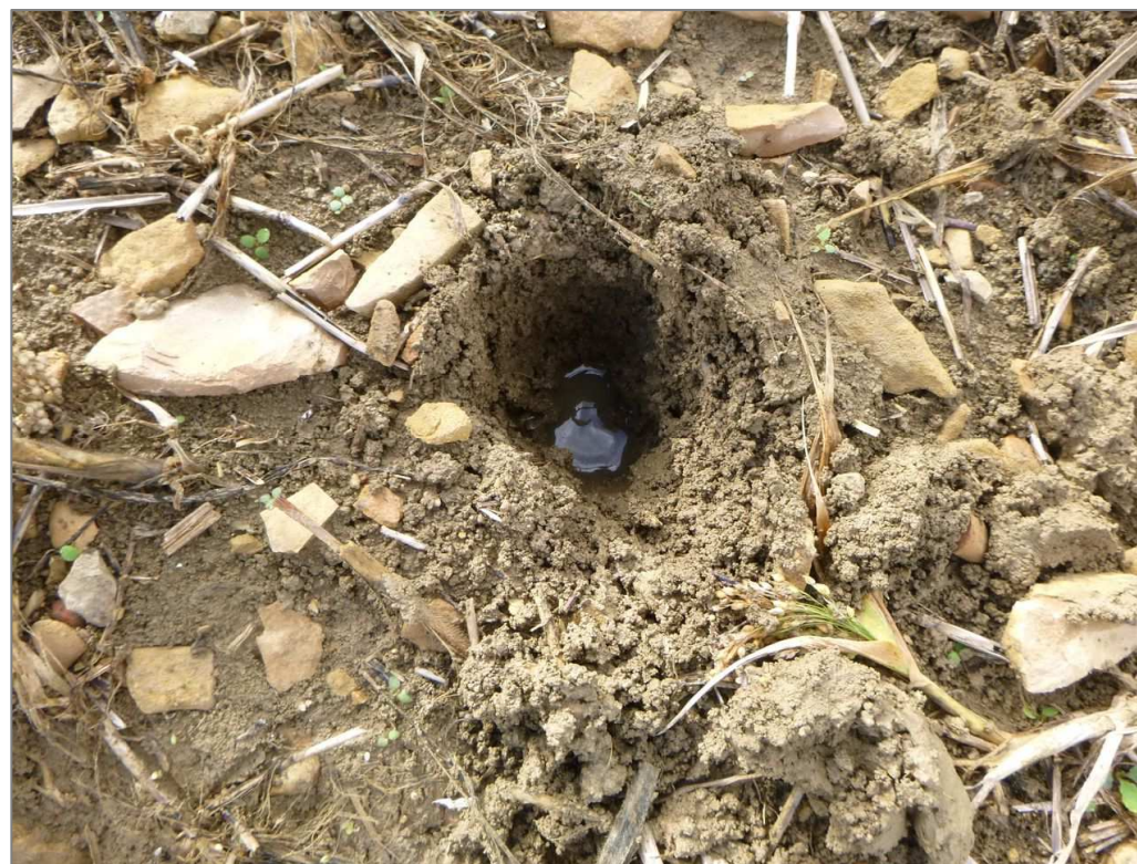
Photographie 5 : Présence d'eau dès les premiers centimètres (sondage n°2) et photographie du sondage n°8 (horizon réductique à partir de 10 cm)
